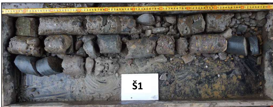
Obr. č. 2 - diagnostický vrt Š1 - pod úroveň základové spáry opěry Olomouc
