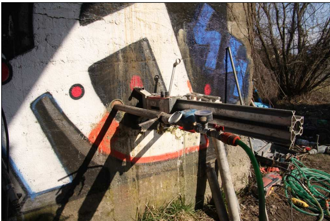
Obr. č. 8 – provádění vodní tlakové zkoušky ve vrtu V2 - opěra Uničov
