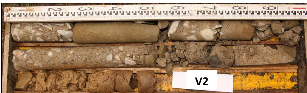
Obr. č. 3 – diagnostický vrt V2 - za rub opěry Uničov
